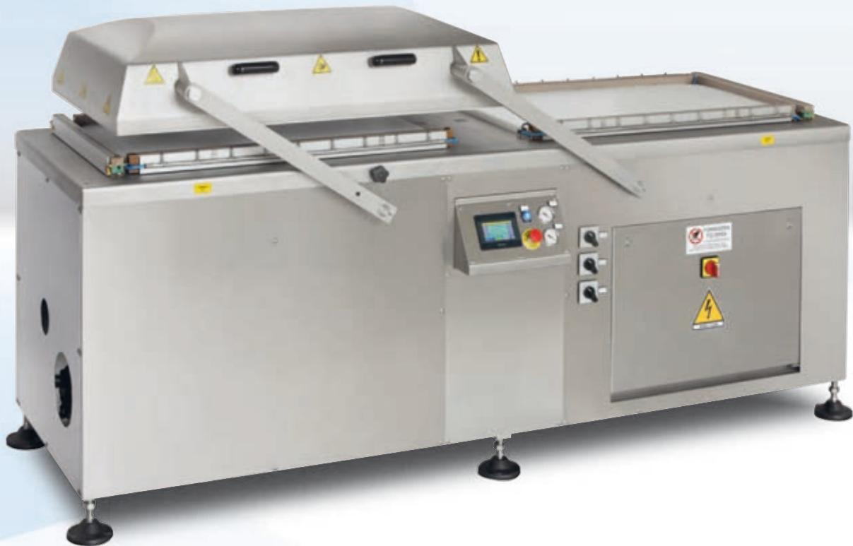
Costruita interamente in acciaio inox con piani di lavoro facilmente pulibili di serie. Doppie barre saldanti, saldatura sopra e sotto per una perfetta saldatura, possibilità di saldare qualsiasi tipo di sacco, essenziale ed ergonomica, facile da pulire.
