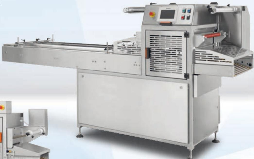
Macchina per la sigillatura e il confezionamento in vuoto o in atmosfera controllata di contenitori preformati di qualsiasi forma mediante la saldatura di film termosaldbili a barriera e non, da bobina o pre-fustellati. Ideale per le esigenze delle piccole e delle medie aziende.
